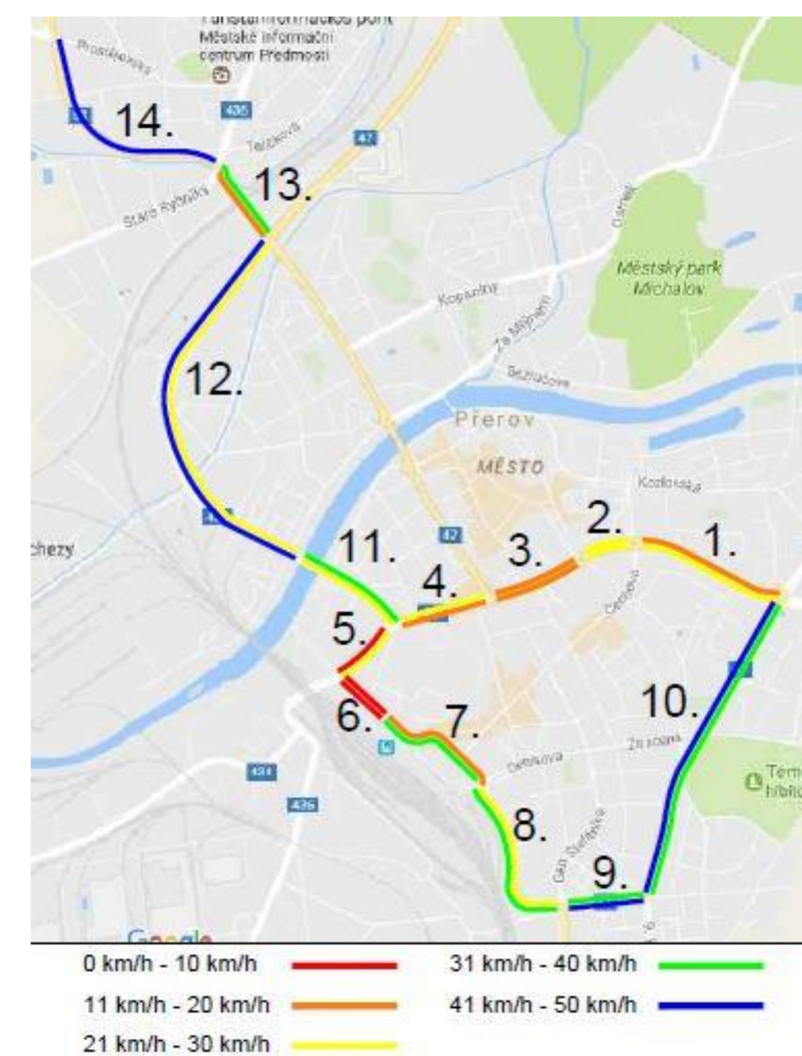
Vyhodnocení průzkumu plovoucím vozidlem (Evaluation of Floating car survey)
